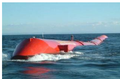
Slika 10.5. Offshore konvertor snage talasa ([16], [27])
